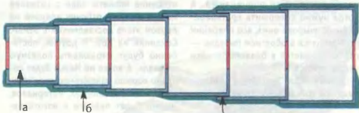
Рис. 6. Жилой модуль в развернутом состоянии: а) цилиндр наименьшего диаметра с двумя люками — шлюзовая камера; б) покрытие из быстротвердеющей пены; в) узел герметизации.
